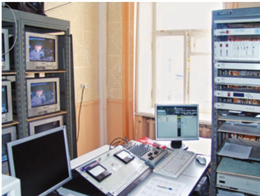
Аппаратная региональной врезки в ТВК «Россия-2» (ГТРК «Южный Урал», Челябинск). Здесь установлена система «Форвард ТА» и множество устройств фирмы «Профитт», включая оптические модули, коммутаторы, синхронизаторы, процессор PVDP и т.д.
